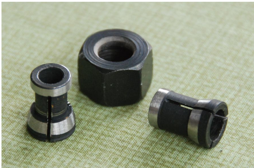
Le système de serrage de fraise.
