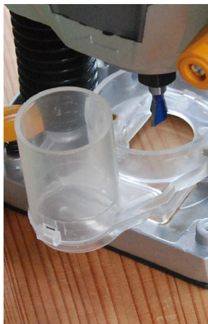
Un collecteur de copeaux permet le raccordement à une aspiration.
