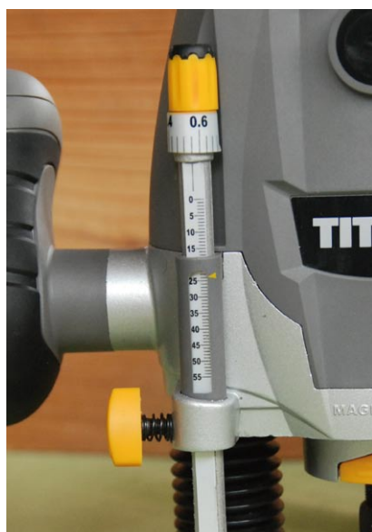
La butée de descente est munie d'index en millimètres, mais la bague de réglage micrométrique n'est pas fiable.
